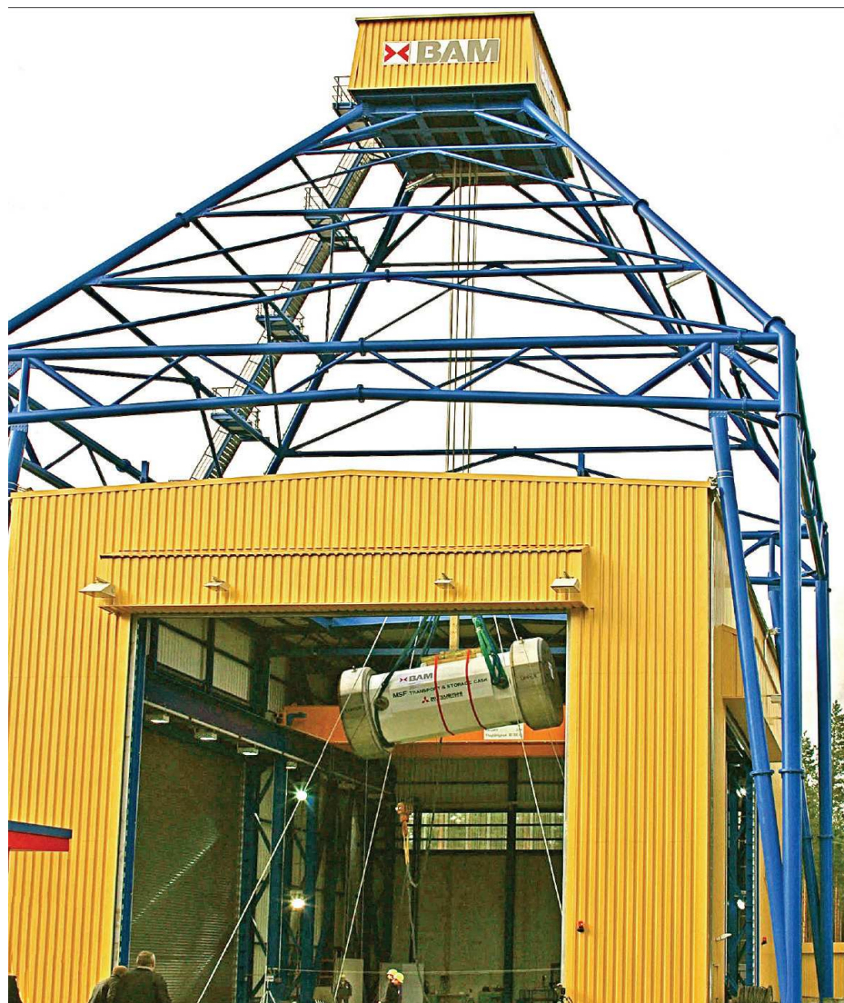
Obr. 3 Plný kontejner před zkouškou pádem (drop testem) ve zkušebním zařízení BAM
